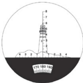
Beispiel: Die Objekthöhe des abgebildeten Leuchtturms beträgt 60 m. Für die Höhe des Leuchtturms kann auf der Strichplatte der Wert 6,0 abgelesen werden.
