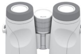
Quando viene utilizzato con gli occhiali, avvitare completamente l'oculare in senso orario.
