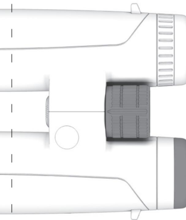
I tillegg lukker man det høyre øyet og ser med det venstre øyet gjennom kikkerten på et objekt. Innstill dette objektet skarpt.
