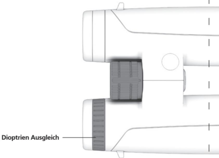
Im Anschluss schließen Sie das linke Auge und blicken mit dem rechten Auge durch das Fernglas auf ein Objekt. Stellen Sie dieses Objekt nun mit dem Dioptrienausgleich scharf.
