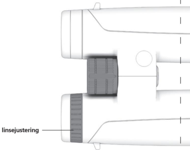
I tillegg lukker man det venstre øyet og ser med det høyre øyet gjennom kikkerten på et objekt. Innstill nå dette objektet skarpt med linsejustering.
