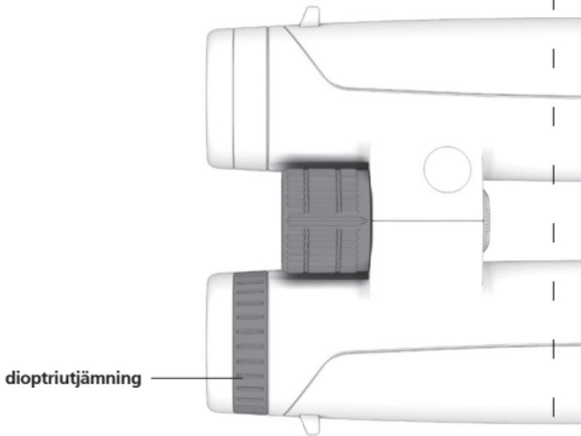
Därefter slutar du vänster öga och tittar med höger öga genom kikaren på ett objekt. Fokusera nu detta objekt skarpt med dioptriutjämning.
