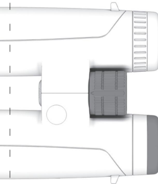
Seguidamente, cierre el ojo derecho y mire con el izquierdo por el prismático a un objeto. Regule hasta que se vea nítido.
