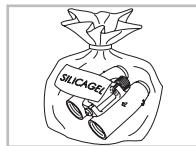
Lorsque les jumelles sont mouillées, il faut au préalable les sécher. Dans les zones tropicales ou dans des régions où règne une forte humidité ambiante, le mieux est d'entreposer vos jumelles dans un étui étanche à l'air doté d'un produit absorbant l'humidité (du type Silicagel).
