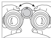
Ved at dreje på fokusringshjulet kan du stille skarpt på objektet, der skal observeres.
